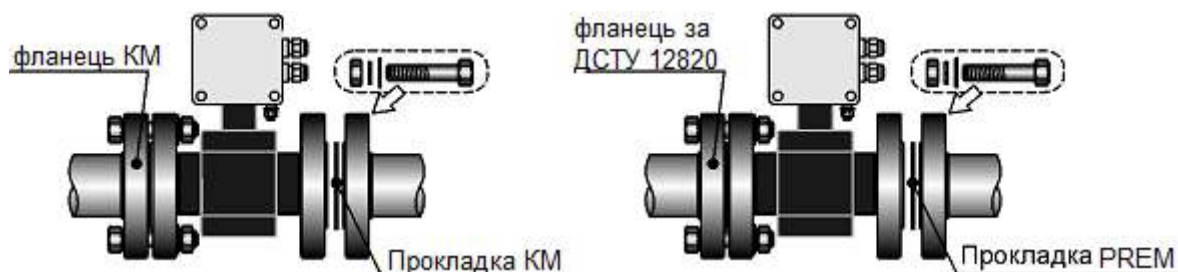
Малюнок 13 — Варіанти монтажу лічильника фланцевого виконання
