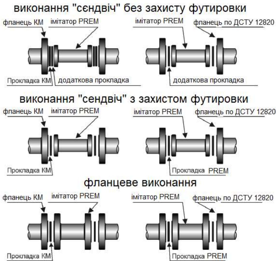
Малюнок 10 — Варіанти установки габаритного імітатора лічильника
