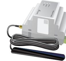
GSM контроллер SMARTLINK M2 предназначен для обмена данными между конечным устройством и веб приложением.
