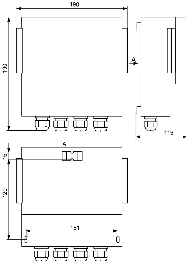
ЭСКИЗ КОММУТАЦИОННОЙ ПАНЕЛИ ЭЛЕКТРОННОГО БЛОКА БЭ-1
