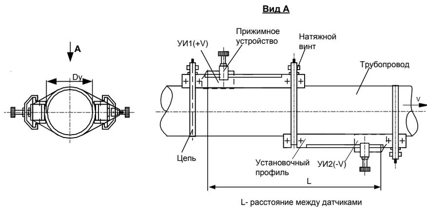
**Вариант крепления с помощью зажима**
