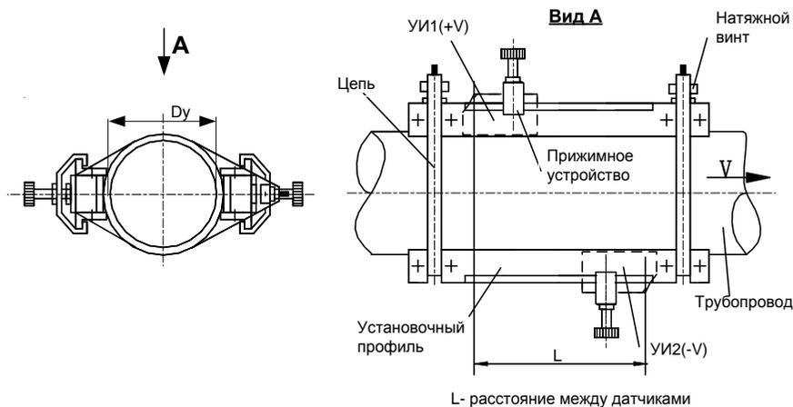
**Вариант крепления с помощью зажима**
