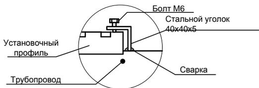
ЭСКИЗ МОНТАЖА ПП-1 ДЛЯ ИЗМЕРЕНИЯ РАСХОДА В ТРУБОПРОВОДЕ С
