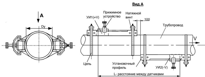
**Вариант крепления с помощью зажима**
